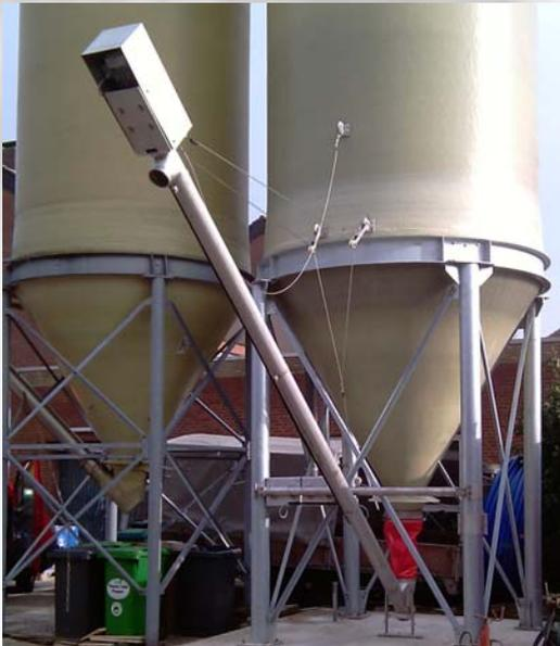
Unterfahrschnecken dienen zur Entnahme von Streusalz aus Silos, meistens zur Befüllung der Streufahrzeuge.
